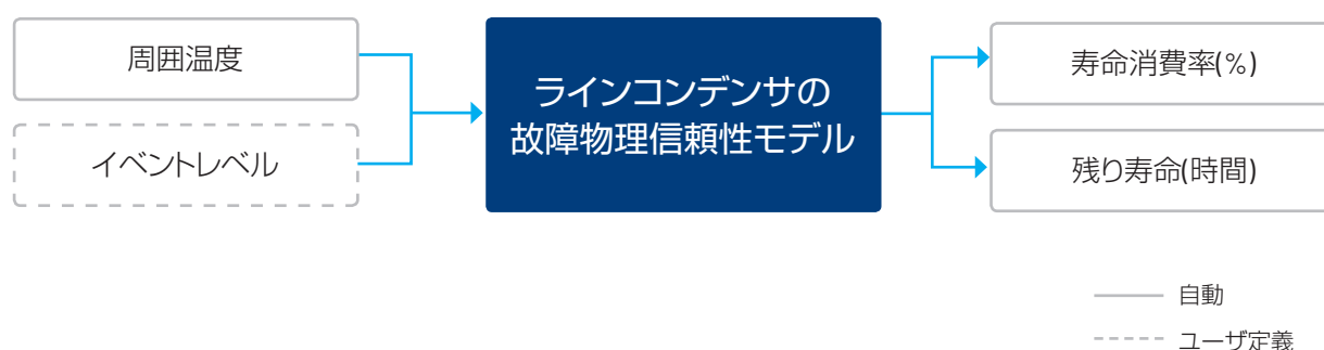
図10 LCLフィルタのコンデンサの予知保全モデルの図
