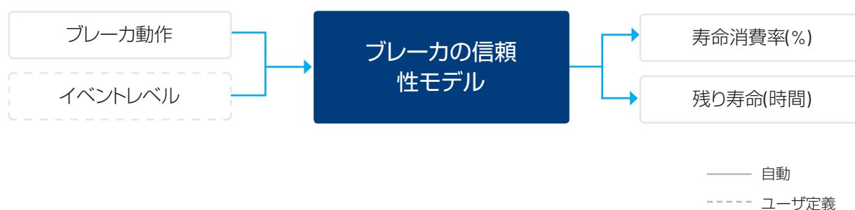
図9 コンタクタとスイッチの予知保全モデルの図
