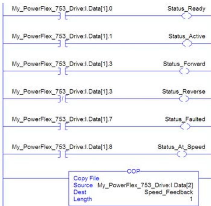
**Figura 21 - Programa de lógica de escalera de ejemplo del controlador ControlLogix utilizando un perfil genérico de variador para el comando lógico y la referencia**
