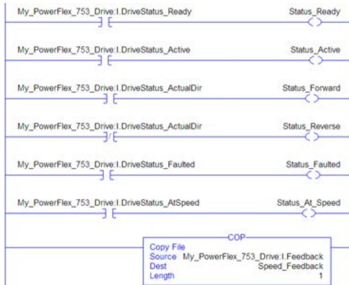
**Figura 17 - Programa de lógica de escalera de ejemplo del controlador ControlLogix utilizando un perfil Add-On de variador para el comando lógico y la referencia**
