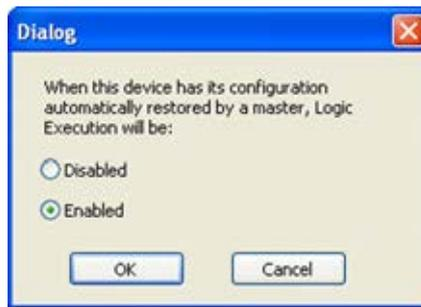
Si no establece el método automático descrito anteriormente para habilitar DeviceLogix después de ADC, podrá hacerlo manualmente. Para habilitar el programa DeviceLogix, establezca el parámetro 53 - [DLX Operation] de DeviceLogix en “0” (Habilitar lógica) mediante uno de los siguientes métodos:
