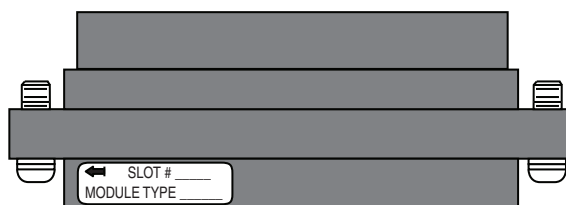
Figura 2.9 Bloque de terminales con protección contra contacto accidental
