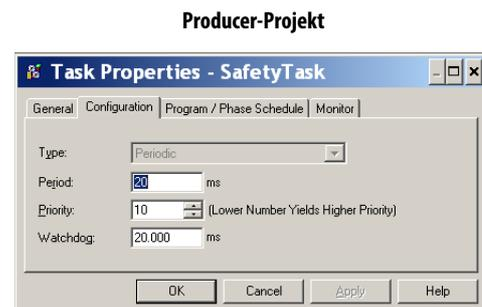
Das angeforderte Paketintervall (RPI) spezifiziert den Zeitraum, in dem die Daten über eine Verbindung aktualisiert werden. Das RPI des konsumierten Sicherheits-Tags muss der Sicherheits-Task-Zeitspanne des produzierenden Sicherheitsprojekts entsprechen.
