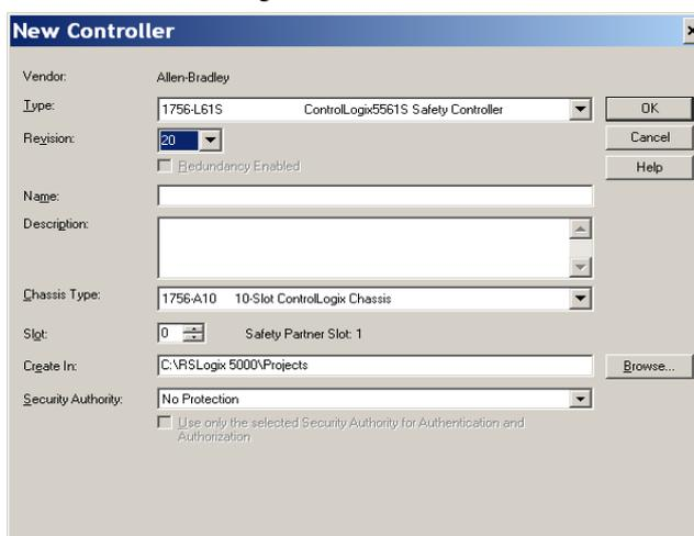
3. Geben Sie die Hauptversion der Firmware für die Steuerung ein.
