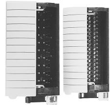
RTB は I/O モジュールには付属していません。これらは別途注文する必要があります。前面に配線アームがある標準のハウジングには、 $2.5\text{mm}^2$  (14 AWG) の配線に十分な奥行きがありません。 $2.5\text{mm}^2$  (14 AWG) を使用する配線を計画しているときは、拡張ハウジングも注文してください。奥行きを拡張したハウジングについては、ロックウェル・オートメーションのナレッジベース記事 #41488 の「Use of the 1756-TBE Extended Terminal Housing」(1756-TBE 拡張奥行き端子台のハウジングの使用) を参照してください。この記事は、<https://rockwellautomation.custhelp.com/> からアクセスできます (ログインが必要)。
