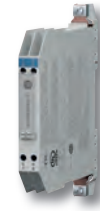
Die Rückföhrungsfunktion der Diode verhindert den Stromfluss in den explosionsgefährdeten Bereichen, weshalb bei Berechnungen der Eigensicherheit von einem Stromwert von null ausgegangen werden kann
