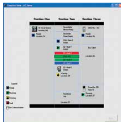
Widok frontu rozdzielni pomaga w szybkim diagnozowaniu układów sterowania silnikami
