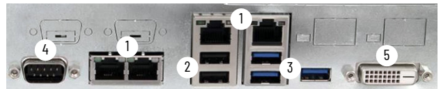
Anschlüsse für Peripheriegeräte an 6300B-PBCx-Box-PCs
