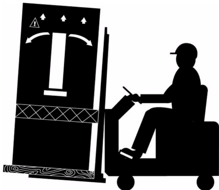
Abbildung 1 Transportieren eines Motor Control Centers mit einem Gabelstapler
