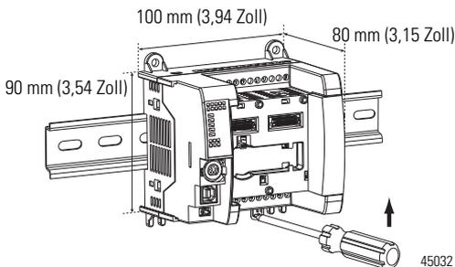
Die Einbaumaße umfassen nicht die Montagefüße und die DIN-Schienenriegel.
