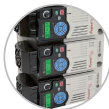
**Flexibilidade** – Todos os inversores PowerFlex série 520 podem ser instalados na vertical ou na horizontal, bem como lado a lado em qualquer orientação. Um kit de ventiladores para o módulo de controle é necessário para a montagem horizontal.
