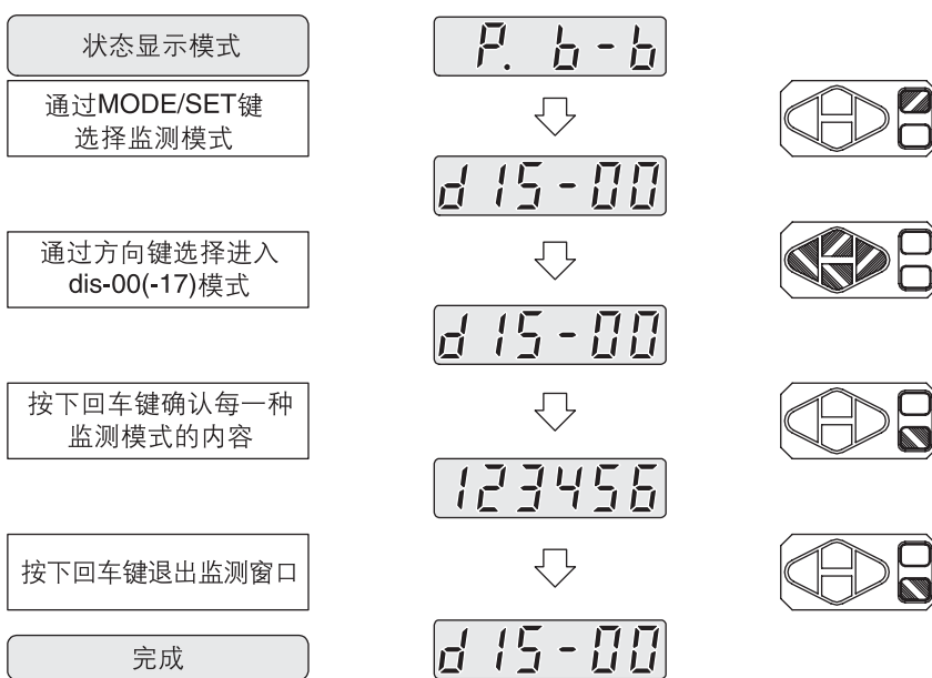
监测模式下按键的操作流程图
