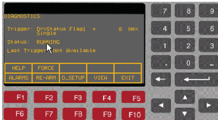
Figura 133 – Diagnóstico – Verificación de estado Status
