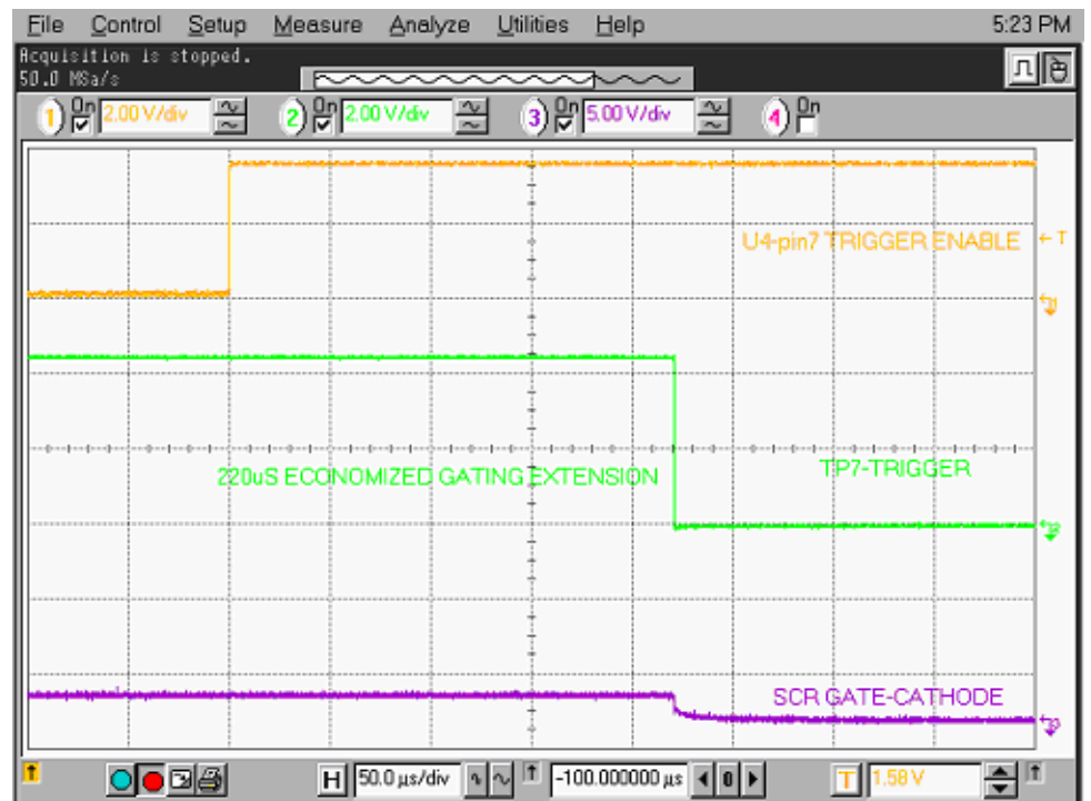
Figura 64 – Expansión de disparo de detección V a impulso de activación de compuerta del rectificador controlado de silicio (SCR)
