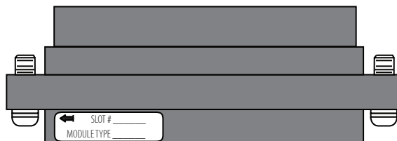
Figura 2.9 Morsettiera con protezione da contatto accidentale
