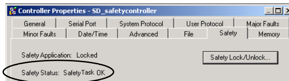
Figura 33 – Estado de la tarea de seguridad
