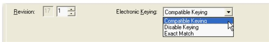
**IMPORTANTE** Mudar as seleções de codificação eletrônica on-line pode fazer com que a conexão de comunicação de E/S com o módulo seja interrompida e pode resultar na perda de dados.
