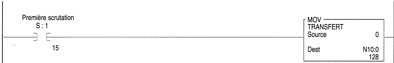
Ligne 2:1 Cette ligne copie les bits d'état BT du 1747-SN dans le buffer d'état virtuel BT.
