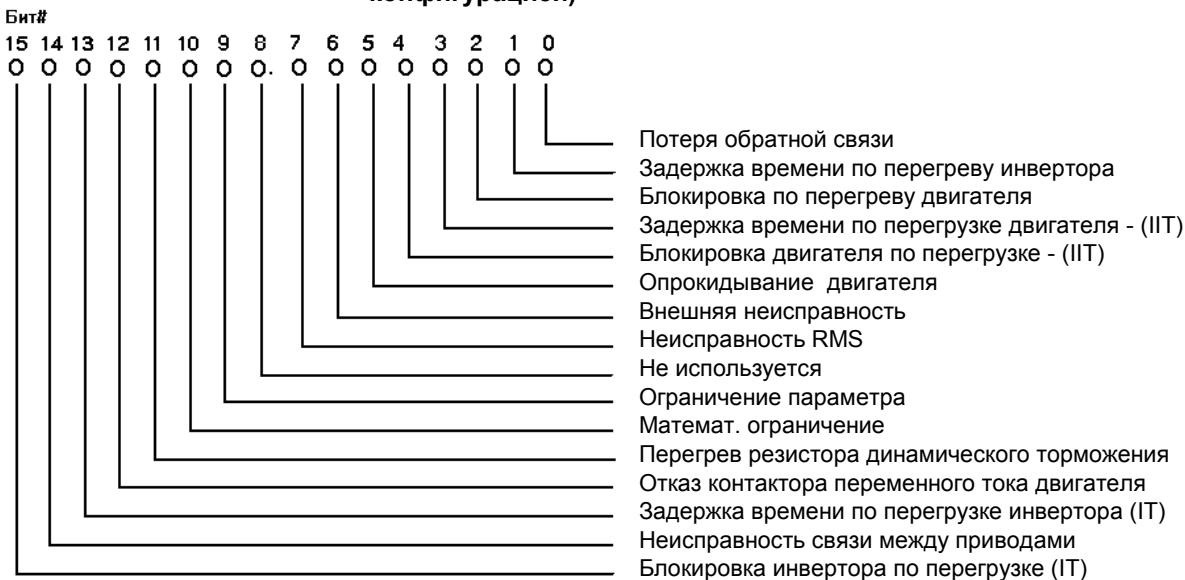
Этот параметр-слово обозначает условия, обнаруживаемые процессором скорости (VP), которые были конфигурированы, чтобы сообщить о предупреждающем условии преобразователя. Каждый бит конфигурации соответствует определениям битов в параметрах 85, 88 и 89. Когда бит установлен на "1", соответствующее условие в преобразователе истинно, в противном случае оно ложно.
