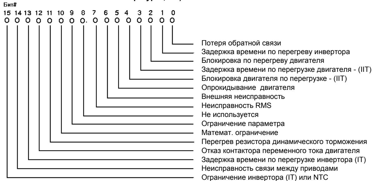
Этот параметр-слово обозначает условия, обнаруживаемые процессором скорости (VP), которые были конфигурированы, чтобы сообщить о предупреждающем условии преобразователя. Каждый бит конфигурации соответствует определениям битов в параметрах 83, 88 и 89. Когда бит установлен на "1", соответствующее условие в преобразователе истинно, в противном случае оно ложно.
