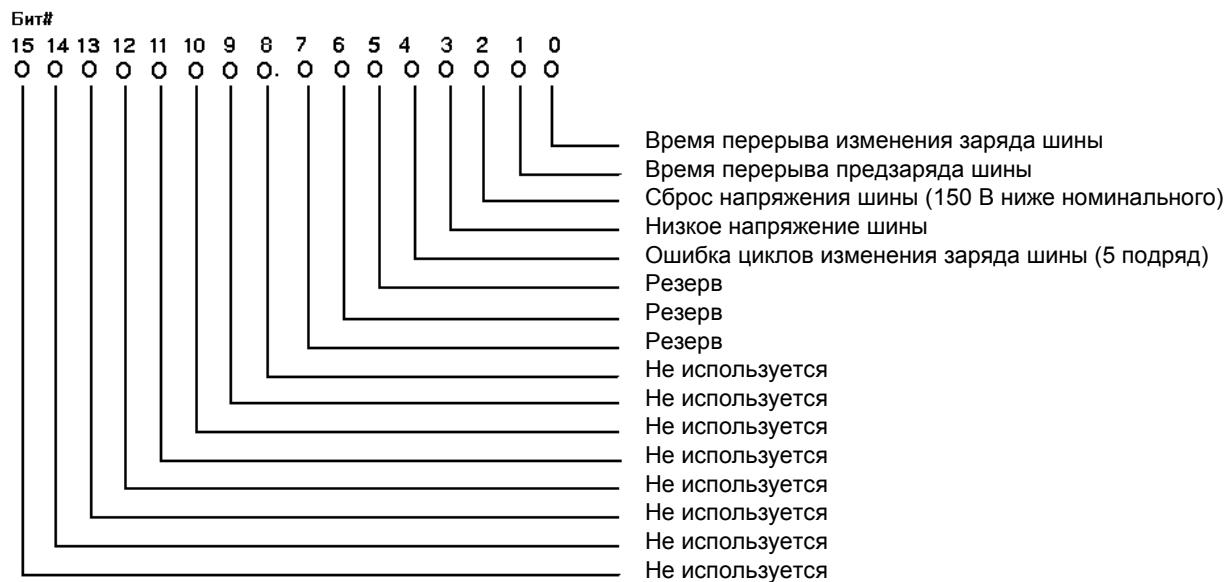
Этот параметр-слово определяет условия, обнаруживаемые процессором тока (СР), которые будут сообщены или как неисправность преобразователя, или как предупреждение, или не будут сообщены вообще (игнорированы). Каждый бит конфигурации соответствует определениям битов в параметрах 82, 84 и 86. Когда бит установлен на "1", соответствующее условие в преобразователе будет сообщено так, как сконфигурировано параметром 86 . Если бит установлен на "0", условие не сообщается.
