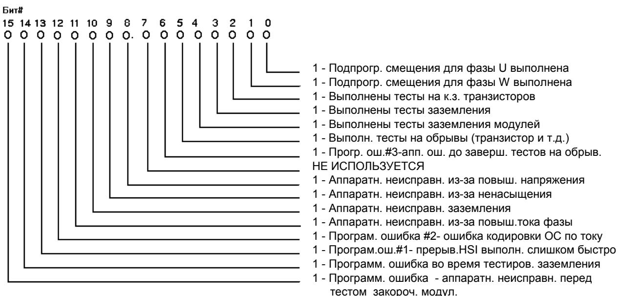
Программная контрольная точка #81 (td\_sm\_counter) перечисляет последние выполненные тесты до прекращения диагностики транзисторов следующим образом:
