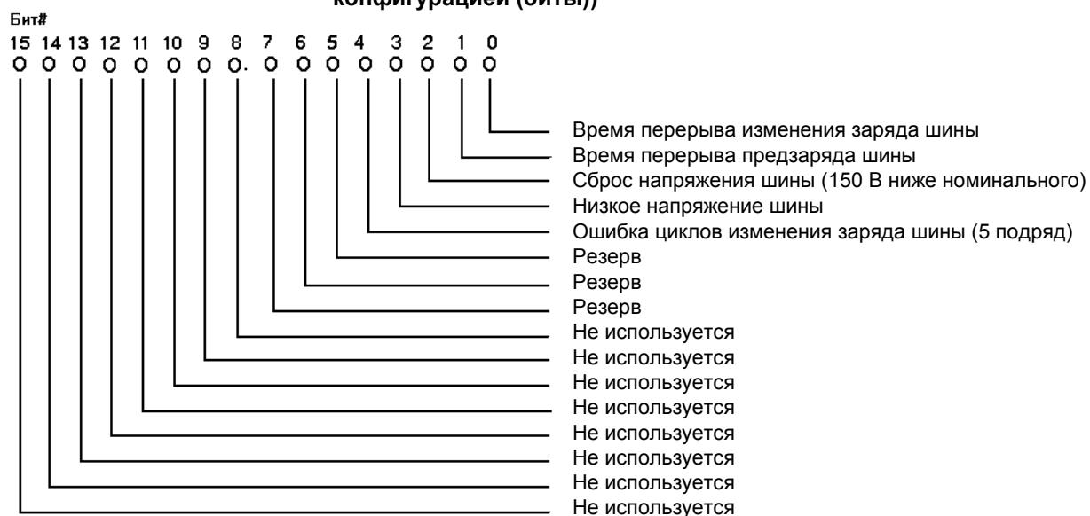
Этот параметр-слово обозначает условия, обнаруживаемые процессором тока (СР), которые были конфигурированы , чтобы сообщить о предупреждающем условии преобразователя. Каждый бит конфигурации соответствует определениям битов в параметрах 82, 86 и 87. Когда бит установлен на "1", соответствующее условие в преобразователе истинно, в противном случае условие ложно.
