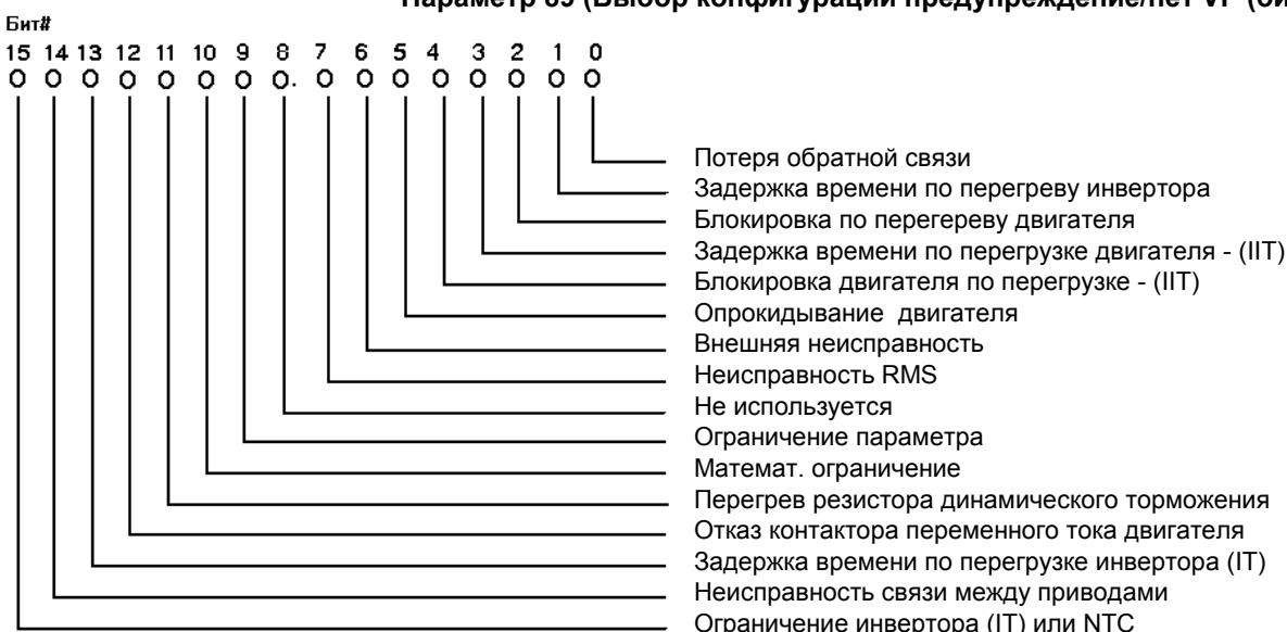
Этот параметр-слово обозначает условия, обнаруживаемые процессором скорости (VP), которые были конфигурированы, чтобы сообщить о предупреждающем условии преобразователя. Каждый бит конфигурации соответствует определениям битов в параметрах 83, 85 и 88. Когда бит установлен на "1", соответствующее условие в преобразователе будет сообщено так, как сконфигурировано параметром 88. Когда бит установлен на "0", условие не сообщается.
