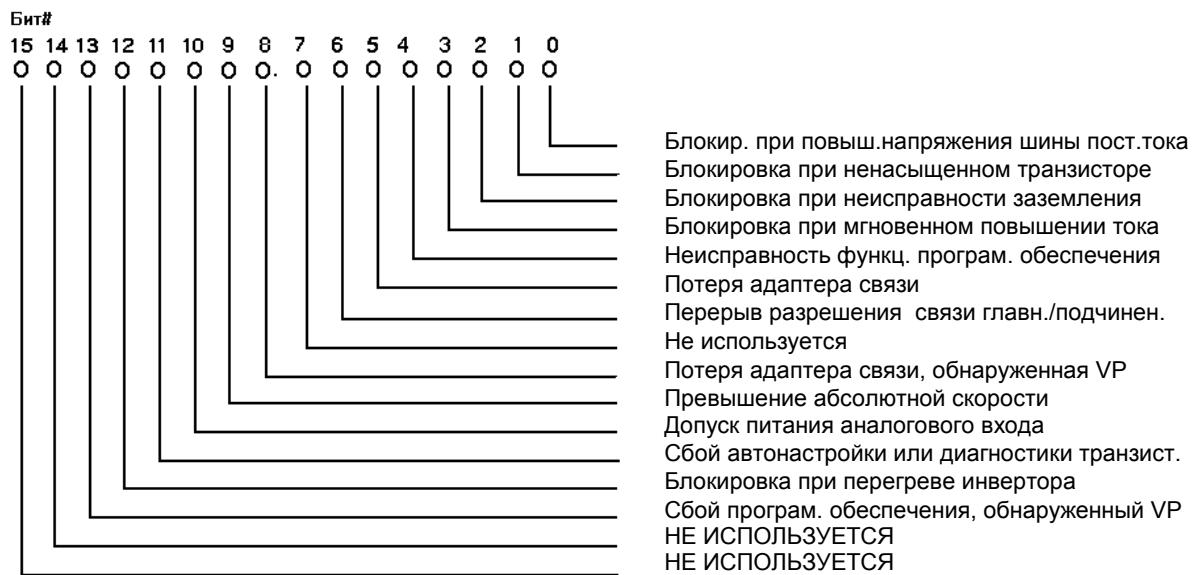
Этот параметр-слово указывает на состояние неисправности в преобразователе, которая НЕ МОЖЕТ быть конфигурирована как предупреждение. Когда бит установлен на "1", соответствующее условие в преобразователе истинно, в противном случае оно ложно. Биты 0-3 обнаруживаются аппаратными средствами, биты 4-15 обнаруживаются программным обеспечением
