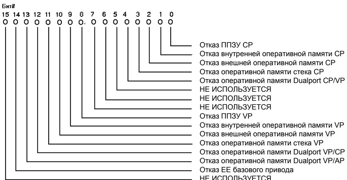
Этот параметр-слово указывает на состояние неисправности в преобразователе, которая обнаруживается при включении питания преобразователя или перезапуске преобразователя. Если бит установлен на "1", соответствующее условие в преобразователе истинно, в противном случае - ложно.
