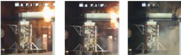
正常な ArcShield テストの実際の写真
