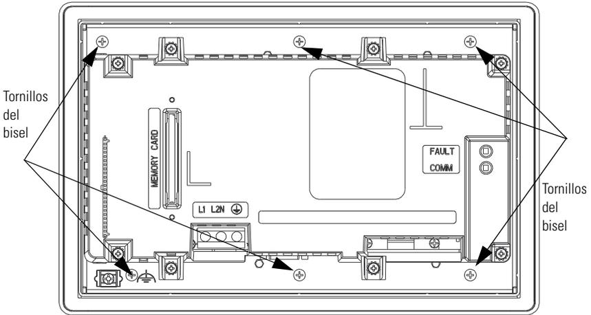
3. Dé la vuelta al terminal de manera que descance sobre la cubierta trasera.
